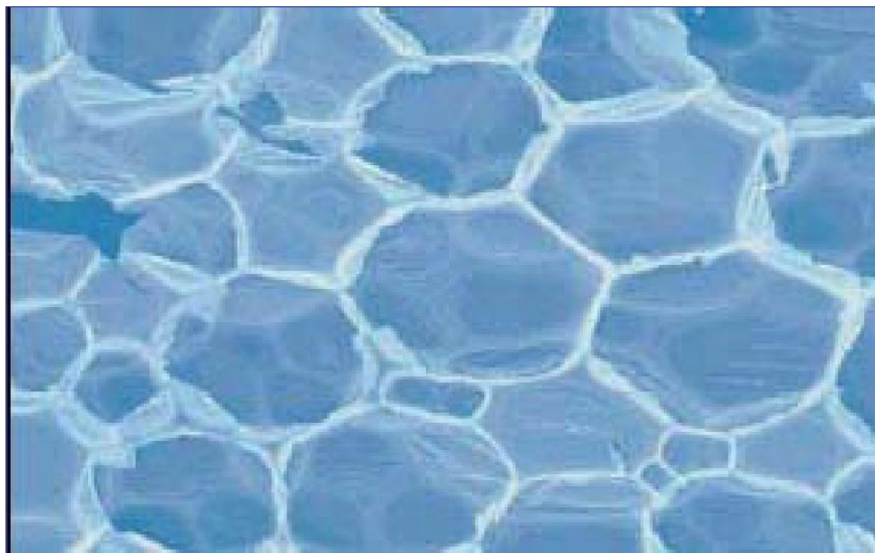
Struktura komórkowa sztywnej izolacji PIR/PUR widziana pod mikroskopem
