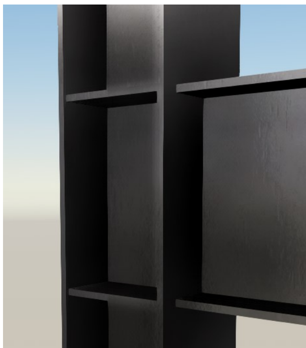
Połączenie 31 Belka spawana do słupa – wizualizacja
